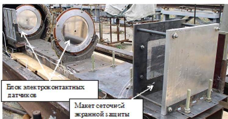
Рис.5. Блок электродатчиков измерения скорости полета ударника и сборки сеточного экрана с пластиной – свидетелем (вид сзади-сбоку) перед размещением в испытательной (вакуумной) камере.
