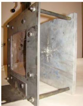
Рис.8. Сборка сеточного экрана с пластиной-свидетелем после эксперимента.
