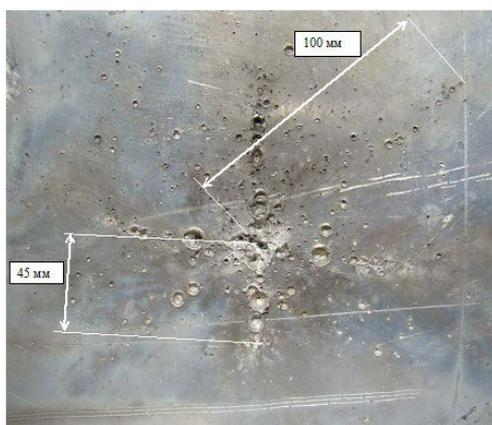
Рис.10. Повреждения на пластине-свидетеле в эксперименте №1 (табл.2).
