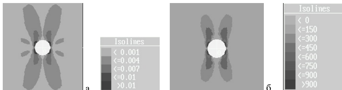
Рис.5. Распределение интенсивности деформаций q_u (а) и напряжений Q_u (б).
