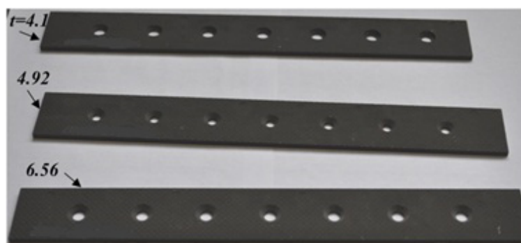
Рис.2. Образцы с отверстиями для установки крепежа.
