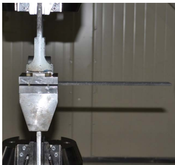
Рис.4. Смонтированные в оснастку и установленные в испытательную машину образцы с отверстием.
