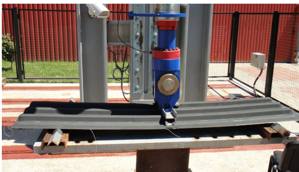
Рис.1. Нагружение трехстрингерной панели из углепластика ВКУ-47И на вертикальном стенде для испытаний крупногабаритных конструкций.
