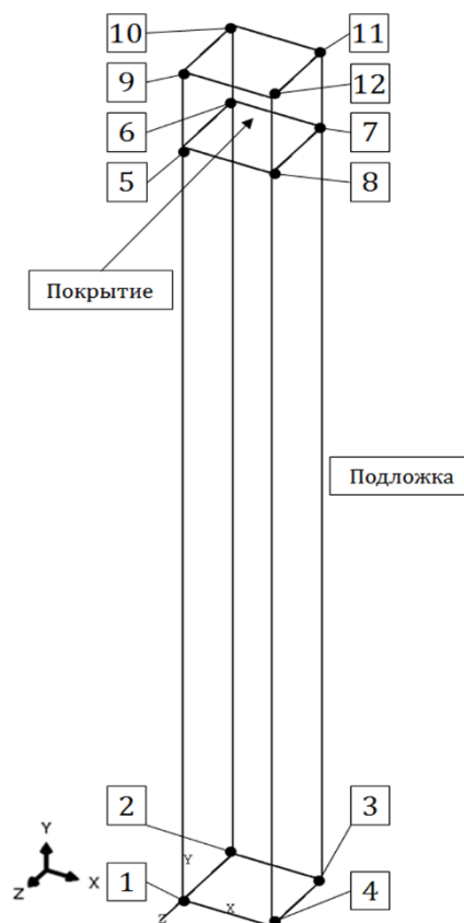
Рис.4. Конечно-элементная модель ( i = 1, 2 \dots 12 – нумерация узлов).
