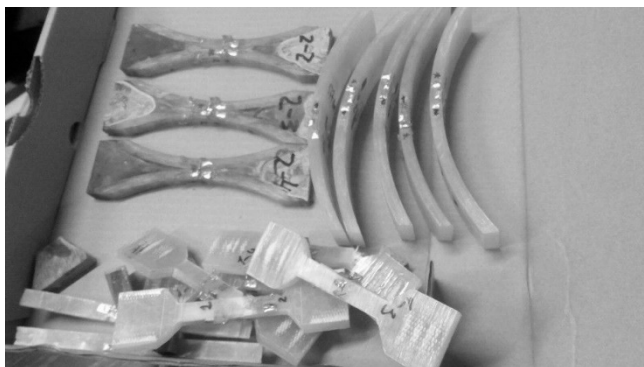
Рис.2. Образцы для испытаний, вырезанные из оболочки макета опоры.
