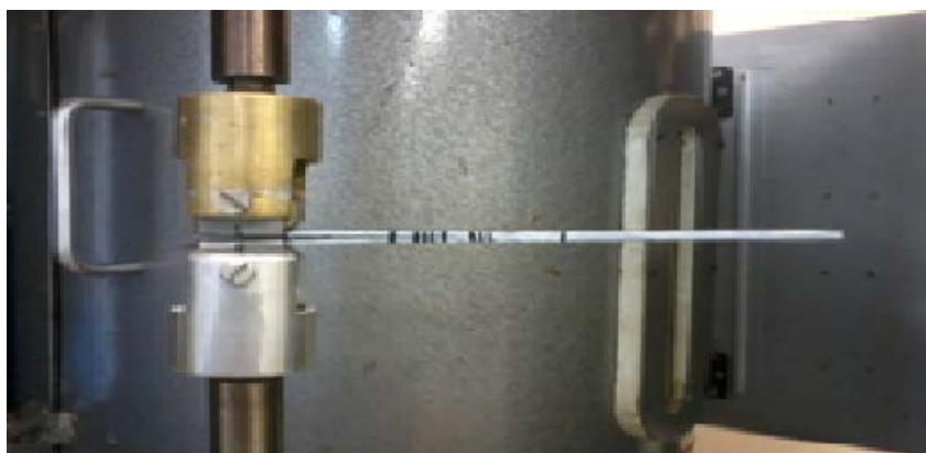
Рис.1. Образец углепластика для испытания межслоевой вязкости разрушения.
