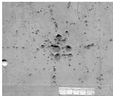
Рис.14. Повреждения свидетеля облаком фрагментов при пробитии алюминиевым ударником D = 6,35 мм стальной сетки 2,0 \text{ мм} \times 0,6 \text{ мм} при скорости 3400 м/с [3].
