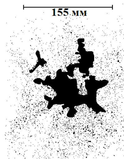
Рис.23. Кратеры и области налёта. Площадь налёта 6505 мм 2 .
