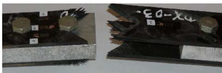
Рис.4. Типовое разрушение образцов при растяжении.
