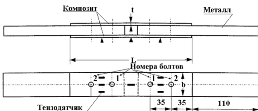
Рис.3. Схема металло-композиционного двухрядного образца.
