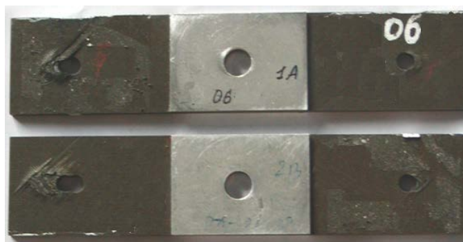
Рис.5. Фотографии образцов №1 после испытаний на смятие.
