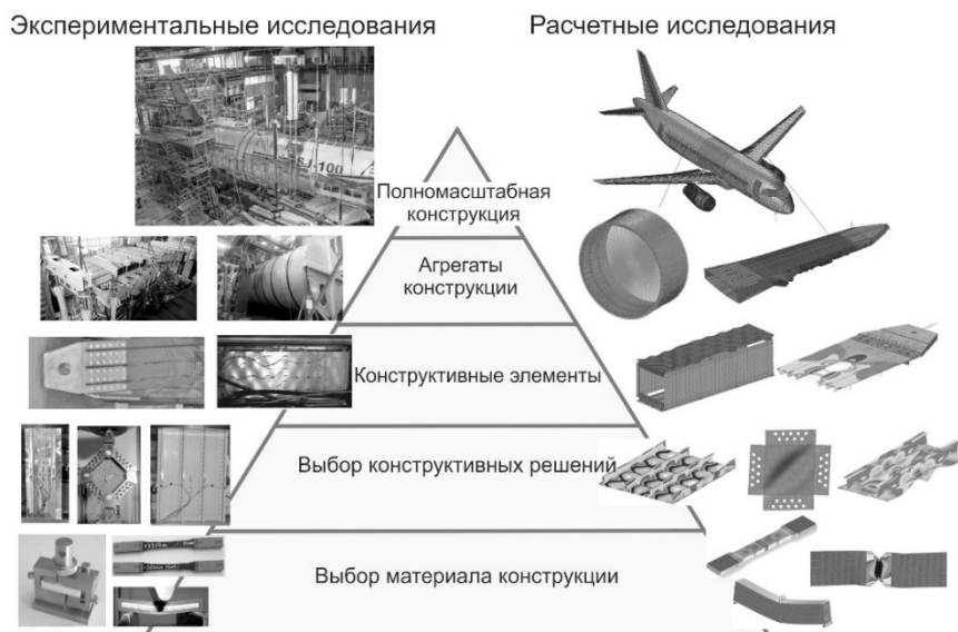
Рис.1. Схема процесса расчетно-экспериментальной отработки прочности конструкции ЛА.
