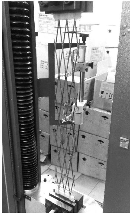
Рис.4. Испытание элемента сетчатой структуры на сжатие.
