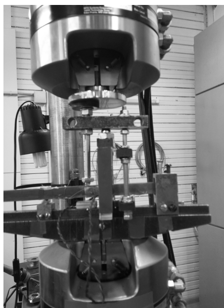
Рис.6. Общий вид устройства для бинарного нагружения образца.
