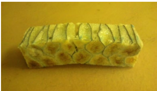
Рис.7. Разрушение образца при испытании на трехточечный изгиб с приложением силы в направлении, параллельном несущим слоям.
