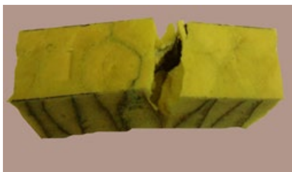
Рис.8. Разрушение образца при испытании на трехточечный изгиб с приложением силы в направлении, перпендикулярном несущим слоям.
