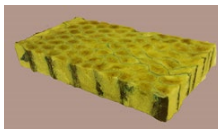
Рис.2. ППУ, армированный БП с размерами ячеек 15 мм.
