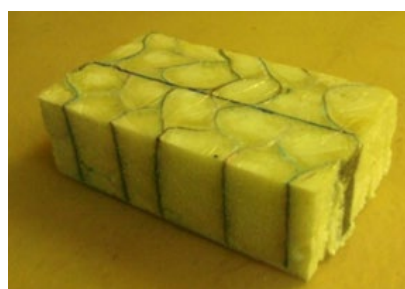
Рис.3. ППУ, армированный БП с размерами ячеек 20 мм.
