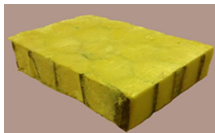
Рис.4. ППУ армированный БП с размерами ячеек 30 мм.
