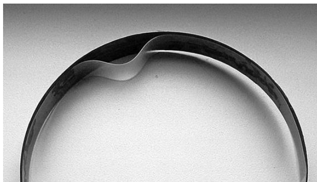
Рис.1. Форма потери устойчивости внутренней оболочки из полипропилена (наружный слой – углепластик).
