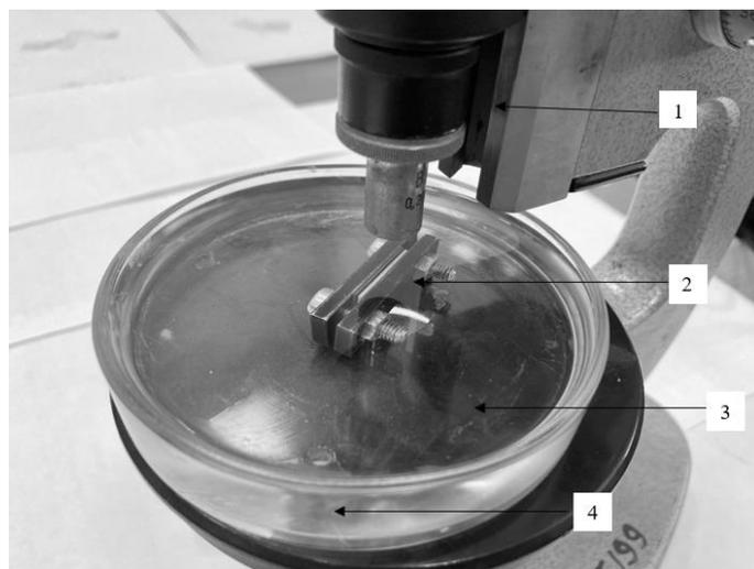
Рис.2. Стенд для макросъемки образцов, где 1 – оптическая система цифрового фотоаппарата; 2 – образец полотна; 3 – модельная жидкость; 4 – чашка Петри.
