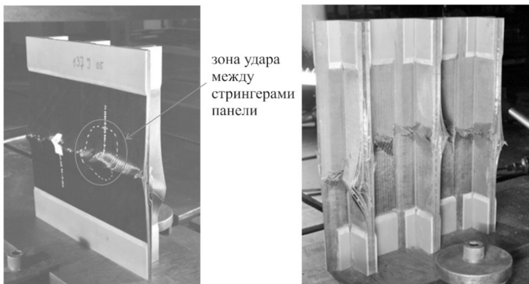
Рис.2. Разрушение стрингерных панелей при сжатии и наличии ударного повреждения.
