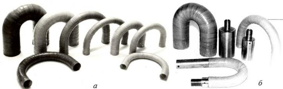
Рис.6. Исследуемые криволинейные трубы-образцы. Типоразмер труб (а), трубы с вклеенными металлическими законцовками (б).
